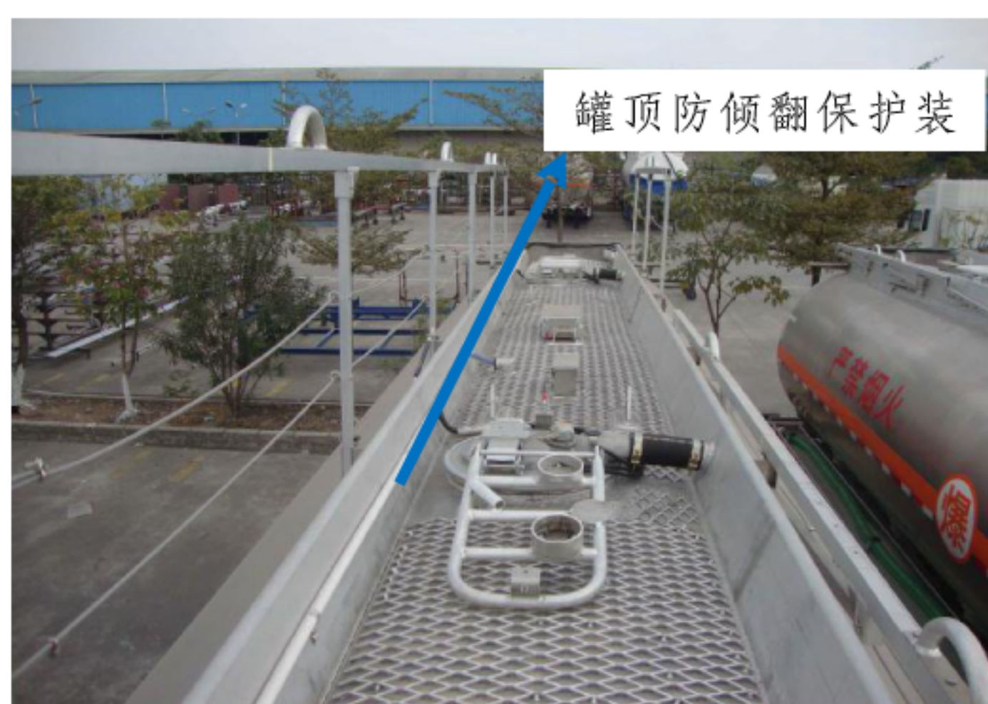
图6-7 罐顶防倾翻保护装置
